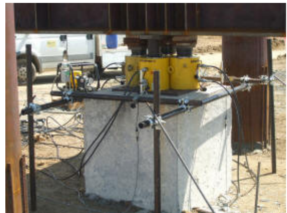
Prova su palo con martinetti idraulici fino ad un carico di 10.000 kN
