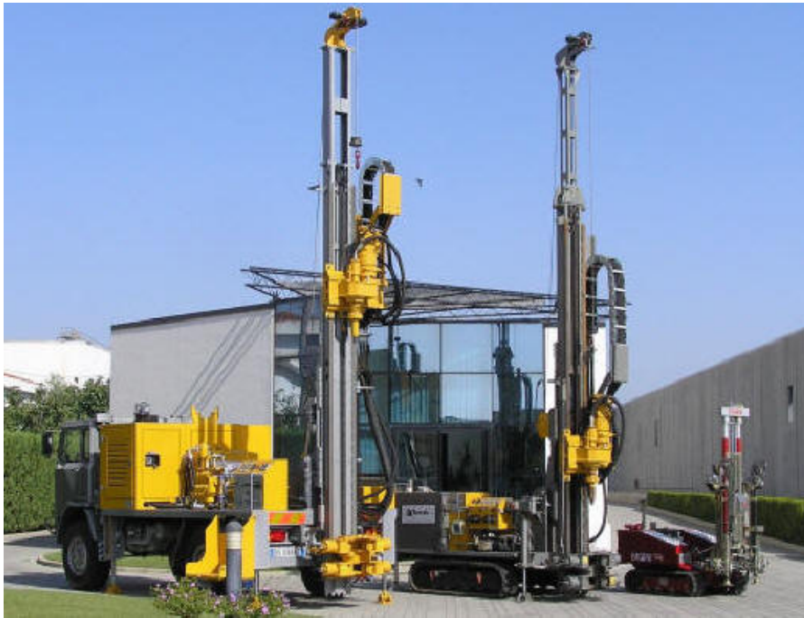
Perforatrici idrauliche e penetrometro da 200 kN statico-dinamico
